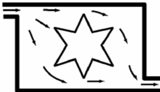
รูปที่ 3.3 Pressurized Type “p” Protection
