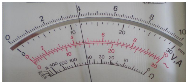
รูปแสดงเข็มวัดชี้ตำแหน่งค่ากระแสไฟฟ้าที่วัดได้
