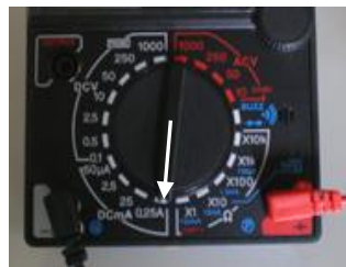
รูปแสดงการตั้งมัลติมิเตอร์เพื่อวัดกระแสไฟฟ้า
