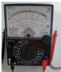
(ก) รูปแสดงการตั้งมัลติมิเตอร์เพื่อวัดความต่างศักย์ไฟฟ้า
