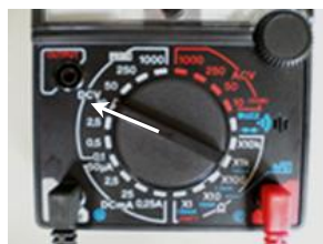
(ก) รูปแสดงการตั้งมัลติมิเตอร์เพื่อวัดความต่างศักย์ไฟฟ้า
