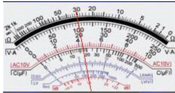
รูปแสดงเข็มวัดชี้ตำแหน่งค่าความต่างศักย์ไฟฟ้าที่วัดได้
